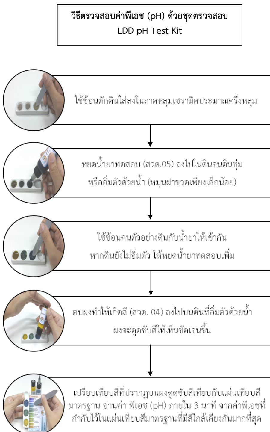
ภาพที่ 6 แผนผังแสดงขั้นตอนการตรวจสอบค่าพีเอชของดิน ด้วยชุดตรวจสอบภาคสนามความเป็นกรดต่างของดิน (LDD pH Test Kit)
